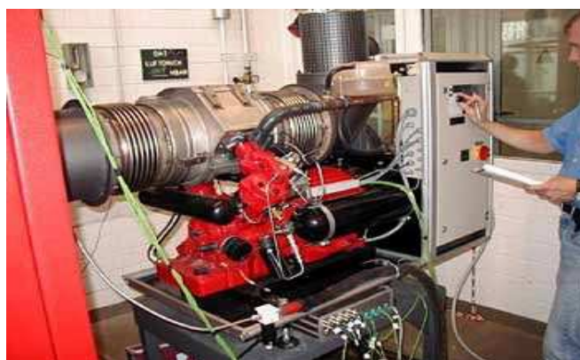
Obrázek: 8 Pokusná kogenerační jednotka na biomasu SOLO Stirling 161
