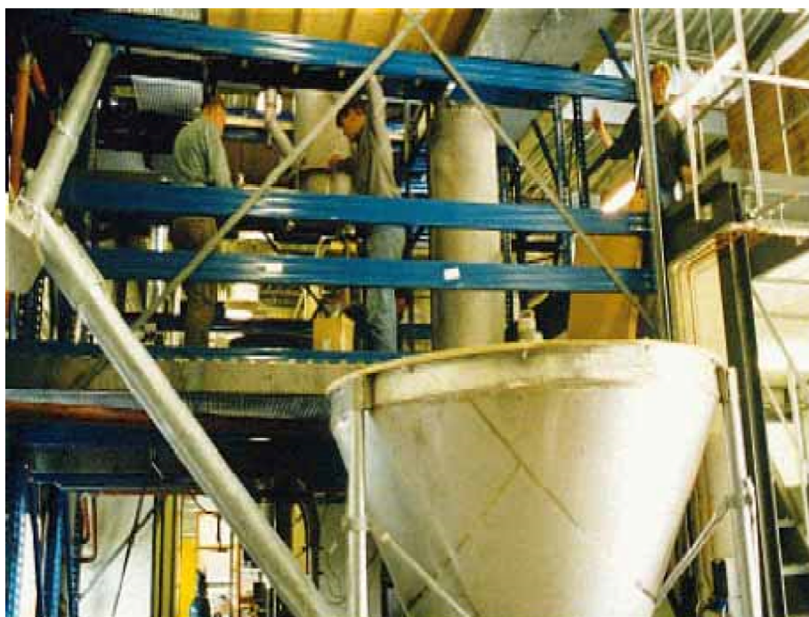
Obrázek :2 Pilotní pyrolýzní jednotka na biomasu s kapacitou výroby bio-oleje 5t/den firmy BTG
